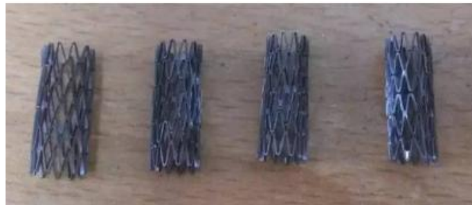
图 2. 可降解镁合金食管支架的样品，经过表面处理后支架呈黑色
